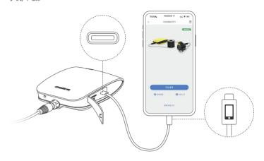
\*注:若连接后无法通信,可打开手机OTG开关,并尝试关闭手机Wifi和蜂窝流量,如还不能正常通信,则该手机/平板可能不支持USB网口功能,请使用Wifi连接方式;
